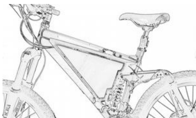
Wykonaj kartonowy szablon wnętrza wykonanej skrzynki elektrycznej
