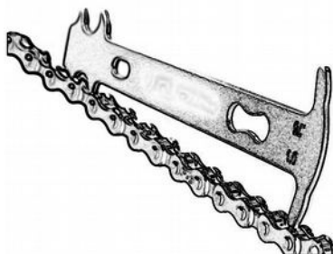
Przymiar łańcucha, badający rozciągnięcie
