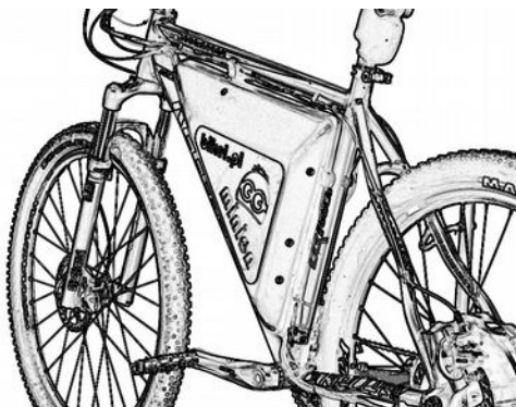
Pojemnik na baterię i elektronikę wykonany z żywicy poliestrowej i maty z włókna szklanego
