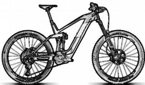
Rower elektryczny fabryczny, z napędem zamiast suportu, z baterią ukrytą w ramie roweru
