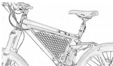
Finalny przymiar kształtu koszyków do wnętrza skrzynki elektrycznej
