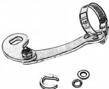
Przykładowa, uniwersalna blokada obrotu (z ang. torque arm)
