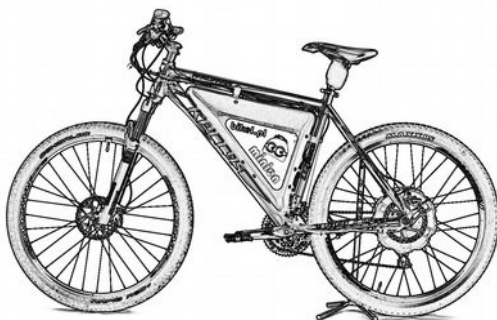
Rower MTB przerobiony na elektryczny
