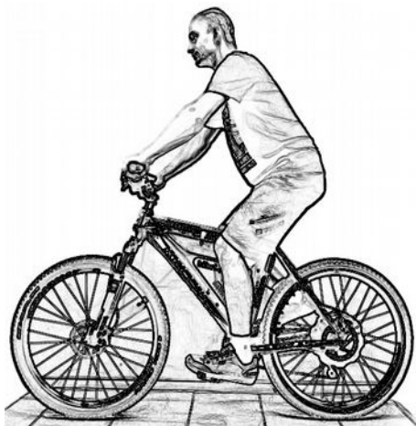
Przykładowa pozycja turystyczna, na rowerze elektrycznym opartym o ramę MTB. Bardziej wyprostowana niż klasyczna, sportowa pozycja MTB
